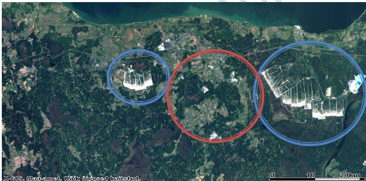
Joonis 2. Põlevkivi kaevandamisest mõjutatud alad Ida—Virumaal. Sinise joonega pealtmaakaevandamine (karjäärid), punase joonega allmaakaevandamine. Ortofoto Maa-ameti kodulehelt.
